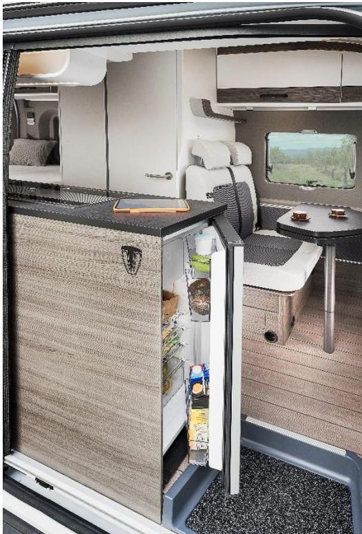
**BU:** Dank des Doppelscharniers kann die Kühlschranktür in beide Richtungen geöffnet werden.
