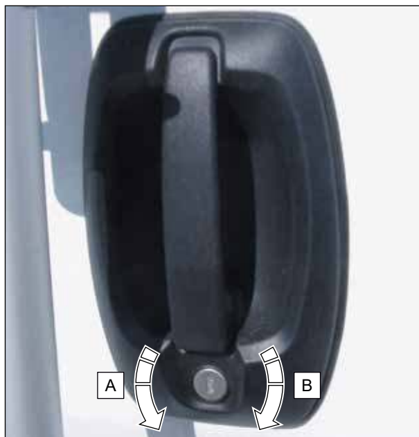
Fig. 13 Abrir y cerrar la primera hoja de la puerta trasera batiente de dos hojas desde el exterior
