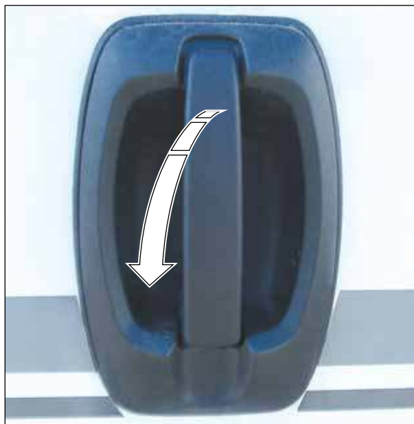
Fig. 10 Abrir y cerrar la puerta corredera desde el exterior
