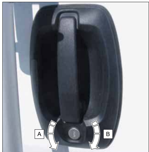
Fig. 13 Apertura e chiusura dall'esterno del primo battente della porta posteriore a due battenti
