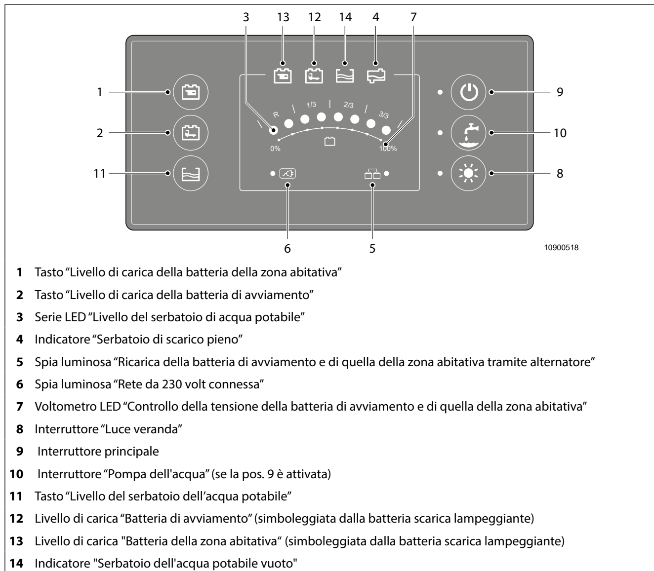
Fig. 54 Pannello di comando di bordo PC -110
